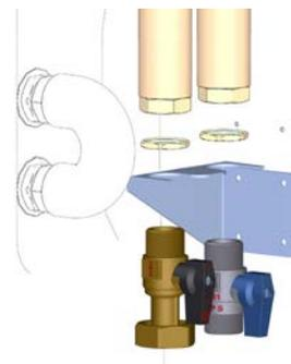
fig. 49 - dettaglio bloccaggio tubazioni su staffa inferiore
