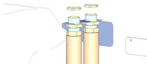
fig. 48 - dettaglio bloccaggio tubazioni su staffa superiore
