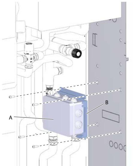
fig. 67 - installazione scatola elettrica
